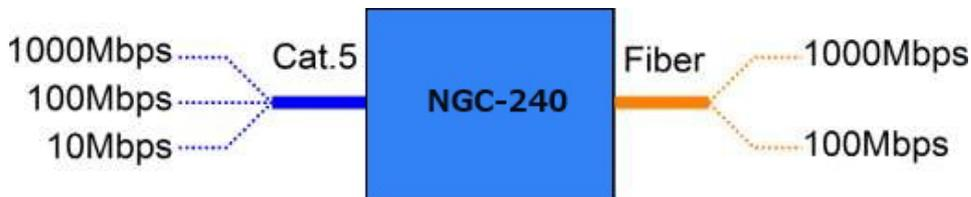
TP ポート側の通信速度は、TP ポートの先に接続されている機種との間で最終的に確立されたリンク・スピードに決定します。
