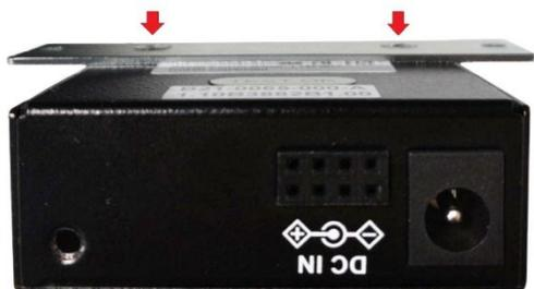
2. 金具(①)の両端の穴に木板取付用ネジ(③)を使用して壁面に取り付けます。
