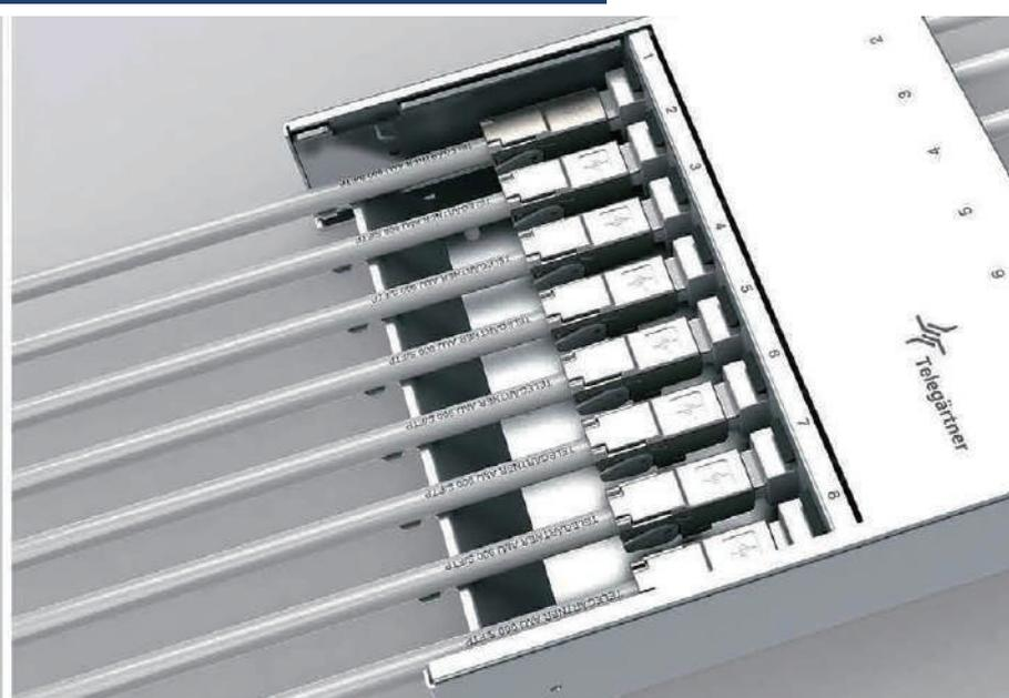
テレガートナー社では、RJ45パッチコードの組み立て用に特別な工具を使用しないIEC60603-7に準拠された様々なデザインのRJ45コネクタをご用意しております。Cat.6AのMFP8コネクタは撚線・単線ともに対応しており、特別な工具を使用せずに現場で簡単に組み立てることができます。最大外径10mmまで対応しており、T568A/T568B/PROFINETの結線タイプを用意しており、360度シールド保護されております。
