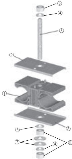
クランプを固定した後にケーブルを挟み込み固定することができるため、安全かつ大幅な作業時間の短縮が可能。
