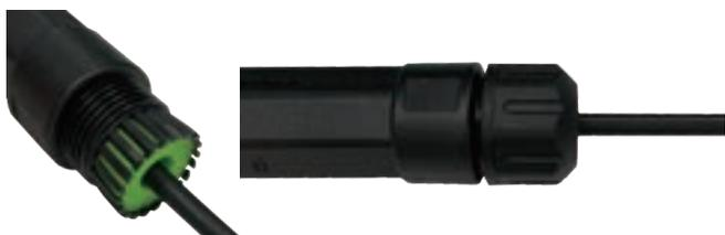
ハウジング内部へ、ケーブルブッシュを奥までしっかり入れた後、トルクレンチ等を使用し、ハウジングとケーブルナットをしっかり締め付けてください。
